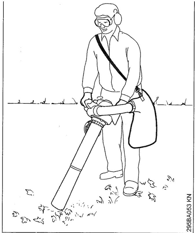
Der Saughäcksler ist für Zweihand-Bedienung ausgelegt. Er muss von der Bedienungsperson mit der rechten Hand am Bedienungsgriff und mit der linken Hand am Griff des Gehäuses getragen werden.
