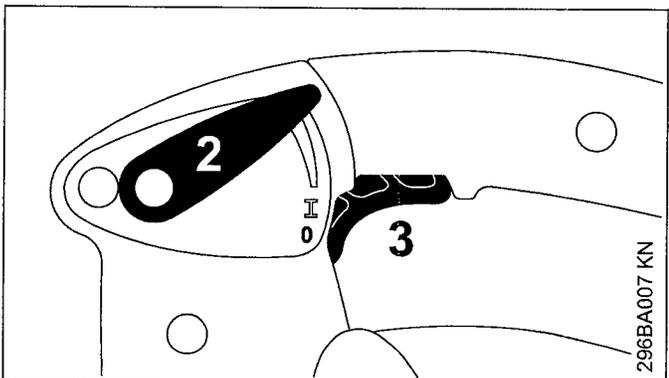
Com a alavanca do acelerador (2), o acelerador (3) pode ser fixado na posição de aceleração máxima durante o trabalho.
