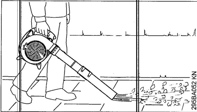
O soprador foi projetado para ser operado com uma mão. Es muss von der Bedienungsperson mit der rechten Hand am Bedienungsgriff getragen werden.
