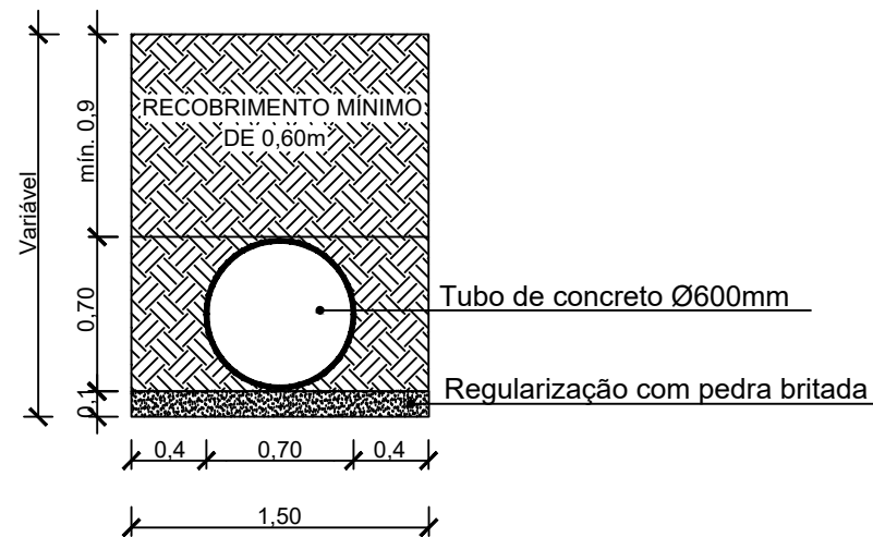
DETALHE 06 SEÇÕES DE ESCAVAÇÃO E REATERRO P/TUBULAÇÃO SEM ESCALA
